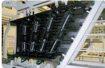
> Bâti d'assemblage du VTP Stub A350 > Mobile line for the HTP VTP
