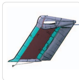
→ Câblage de la dérive VTP de l'A400M
