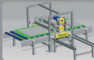
> Machine de préécoupe de plaques de plâtre / Plasterboard pre-cutting machine
