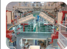
> Poste d'assemblage de la pointe avant A400M > A400M nose cone assembly station
