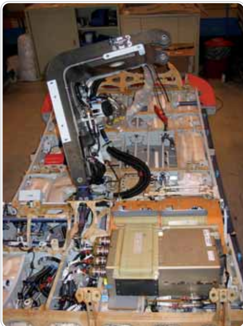
→ Câblage de la porte A380 à comparer aux câblage de la porte A320 → Wiring in an A380 door, compared with the wiring in a A320 door
